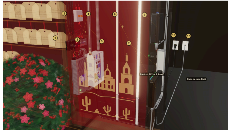
Aparelhos dentro da coluna, a 30 cm do chão ou mais, presos nas paredes: à esquerda o quadro com DR, disjuntor e barras, a fonte do LED, o distribuidor com fusíveis e o dimmer; à direita a régua com a fonte do roteador plugada e o roteador com os plugues encaixados
